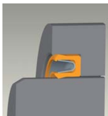
Bild 1: Offene Seite der Dichtung zeigt zur Druckseite
