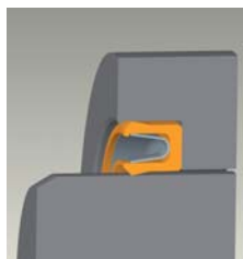
Bild 1: Offene Seite der Dichtung zeigt zur Druckseite
