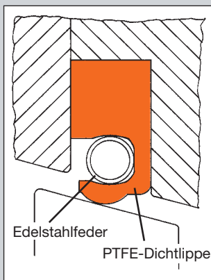
Klappendichtung aus PTFE mit Edelstahlfeder
